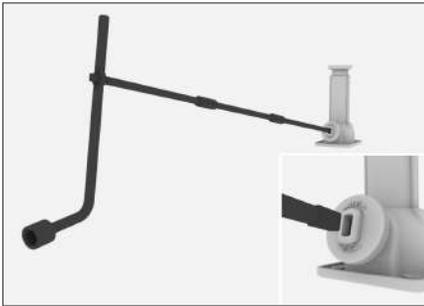
Совместите переднюю, среднюю и заднюю части воротка с баллонным ключом, как показано на рисунке. Затем вставьте вороток в верхнее отверстие домкрата.
